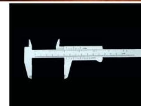
Figura 8. a) Calibre utilizado para la toma de medidas de individuos adultos de Pinna nobilis ; b) Pie de Rey utilizado para individuos inferiores a 20 cm.
