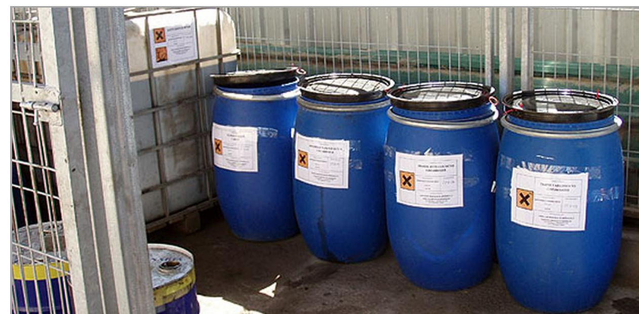
Etiquetado de un contenedor con residuos peligrosos.
