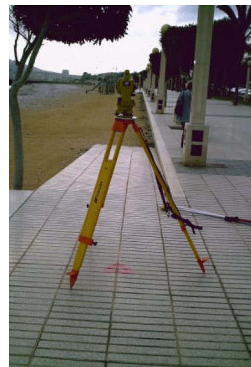
Detalle de la Estación Total sobre un punto de cabecera de perfil (perfil nº5)
