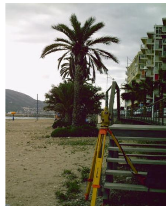
Estación Total para la medida de perfiles topográficos (perfil nº1)
