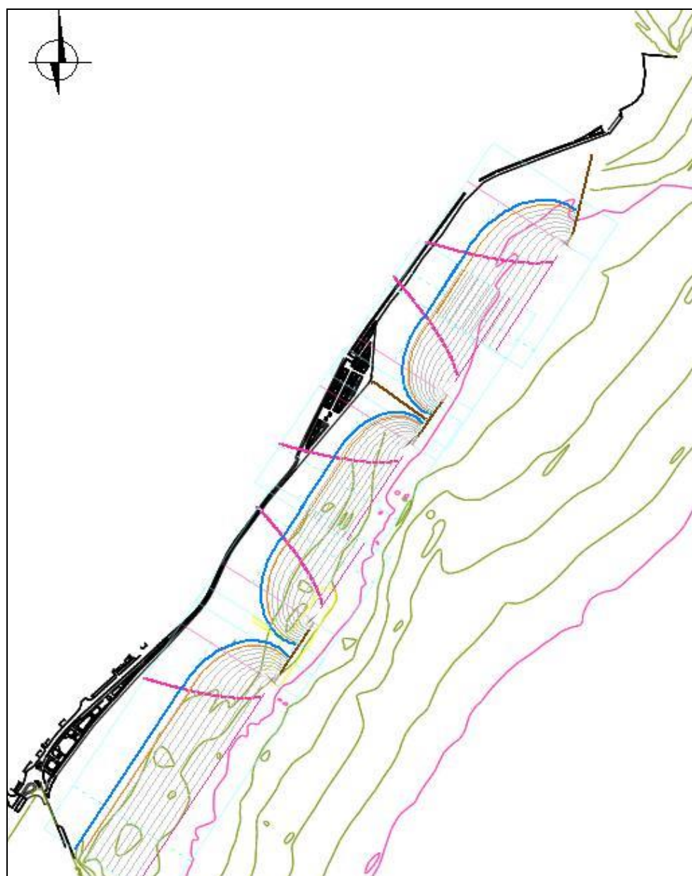
Ajuste en planta de las playas futuras mediante parábolas de Hsu y Evans
