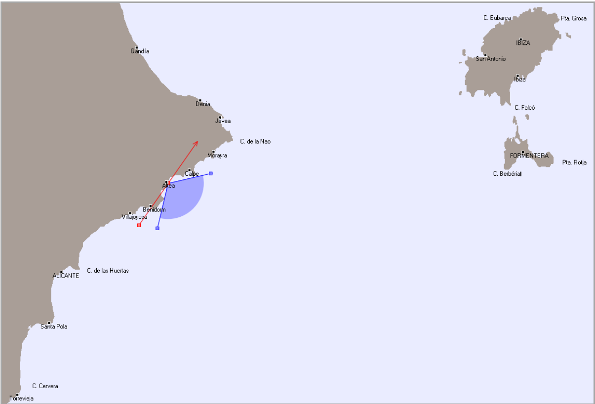
Dirección de la playa de Altea y sector de oleajes que afectan a la costa
